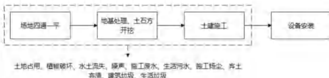
图4-1 本项目施工工艺流程及产污环节
