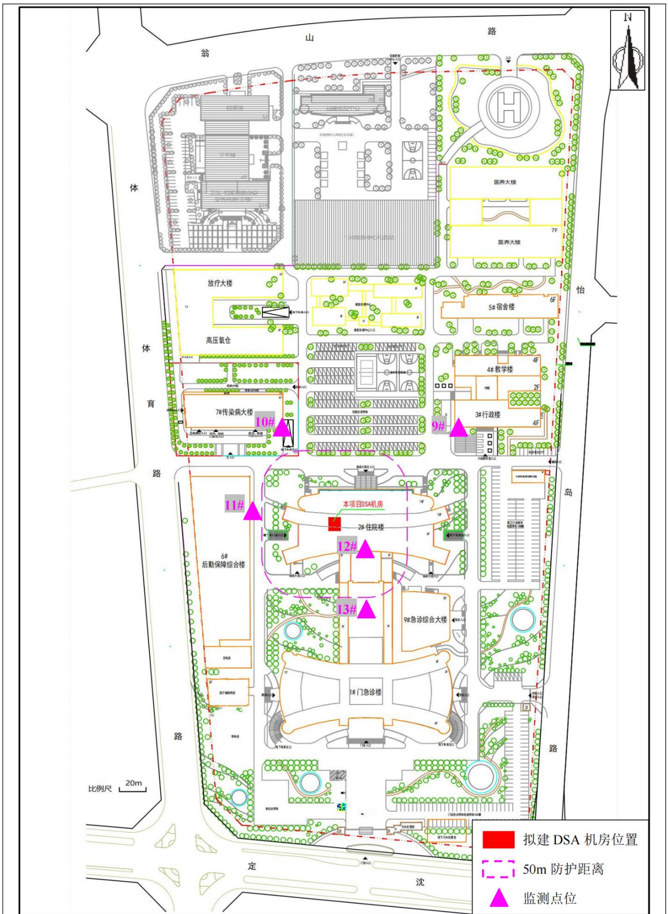
图 8-2 周边环境 \gamma 辐射剂量率监测点位布置示意图
