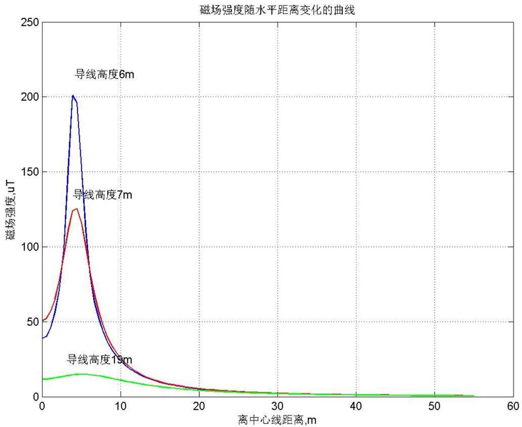
图 3 工频磁感应强度衰减趋势图
