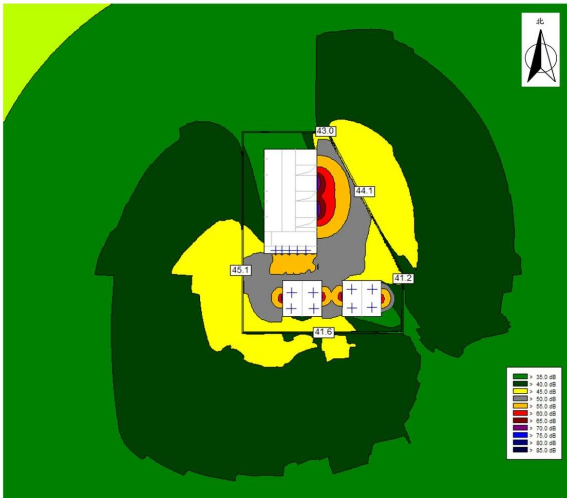
图 4-2 本工程神画 220kV 变电站加装高压电抗器后噪声预测等值线图（预测高度 1.2m）
