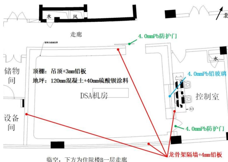
图 1-1 本项目 DSA 机房屏蔽设计示意图
