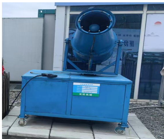
施工期环保措施照片（除尘炮雾机）
