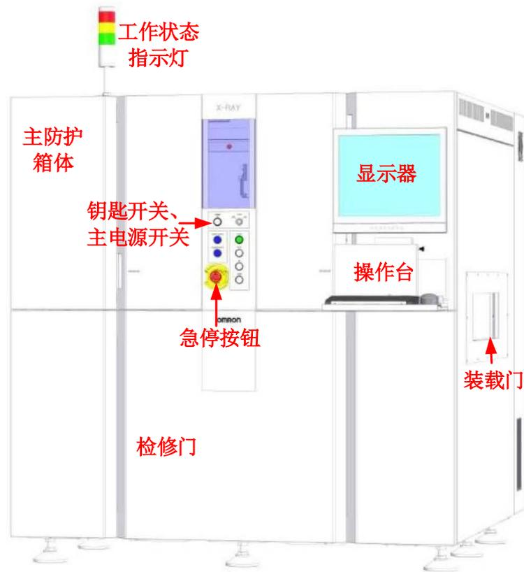
图 9-2 本项目工业 CT 结构外观图
