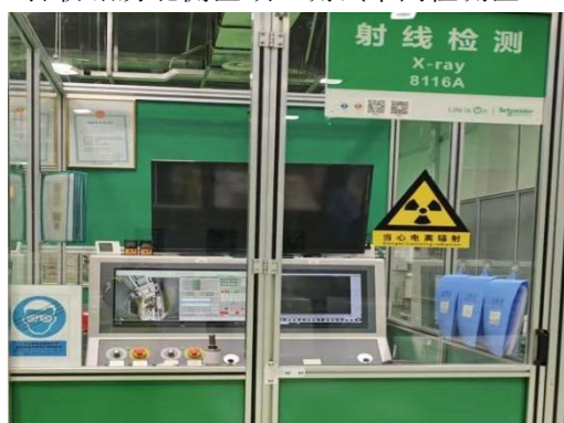
现有探伤铅房围栏区外警告标志
